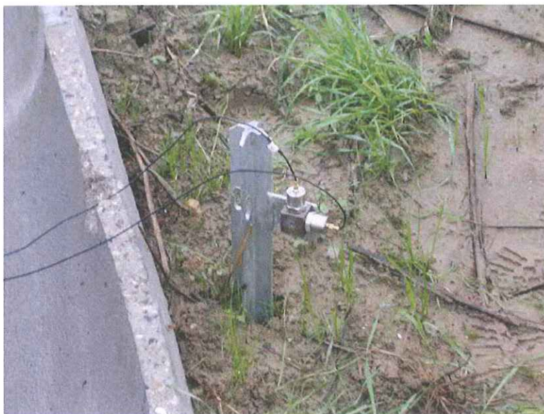
Foto 4. Punta metallica usata per le misure delle vibrazioni
