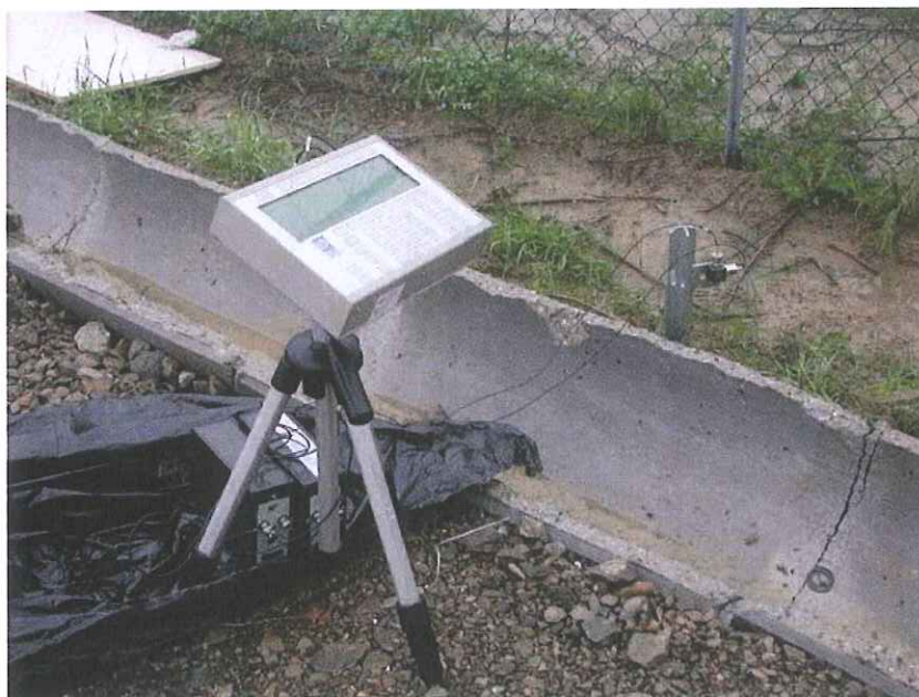
Foto 1 – La catena di misura basata sul modello 2900 della Larson & Davis
